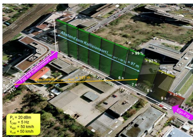
Abbildung 8: Gemessene Reichweite auf einer Kreuzung in der Stadt und ihr Einfluss auf die \text{sim}^{\text{TD}} -Funktion „Querverkehrsassistent“.
