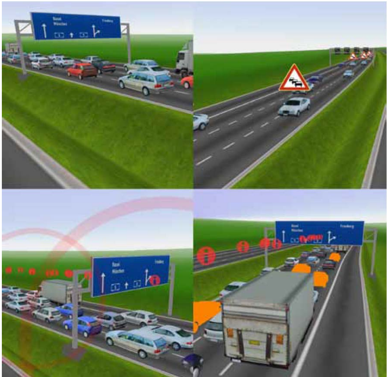
Abbildung 4: Darstellung der Informationsausbreitung der Stauendwarnung auf der Autobahn A5 im sim TD -Versuchsgebiet in der sim TD -Verkehrssimulation.
